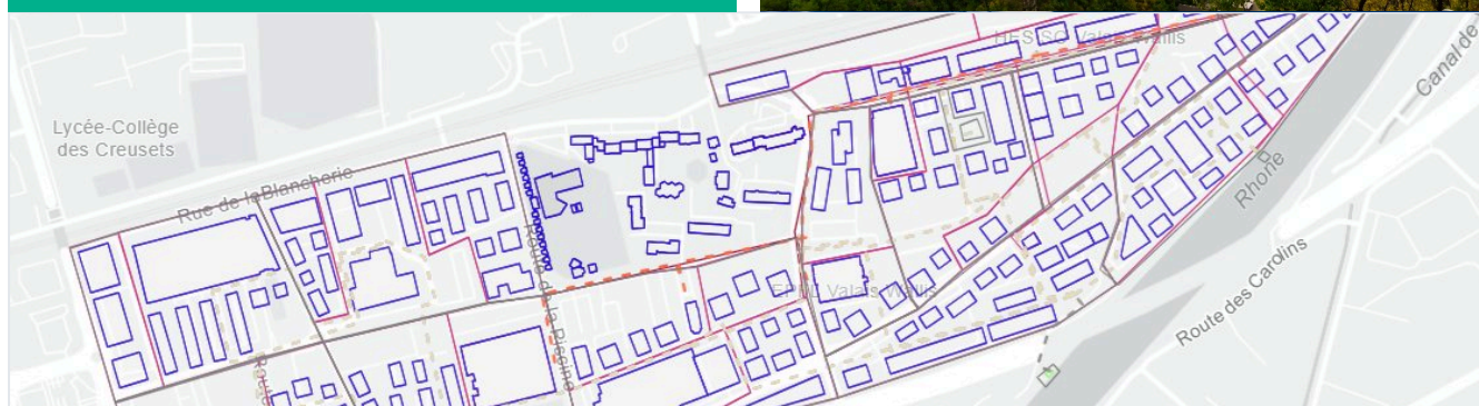
Photo : Gijis Jakobs / Pexels. Plan : le site Ronquoz21 dans l'application web Sympheny, avec environ 200 bâtiments dans 11 secteurs et les tracés de réseau candidats (pointillés).
